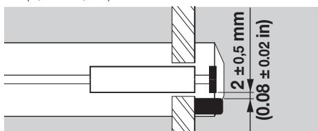
20 На остывшей печи следует проверить керамический насадок через печной фланец.
