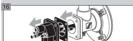
▷ В случае демонтажа газового узла необходимо заменить фланцевую прокладку.
