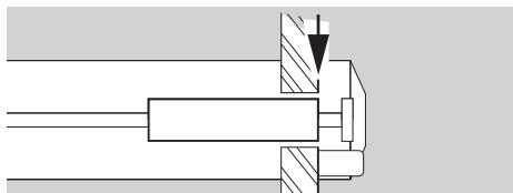
▷ Зазор между электродом розжига и штекером заземления или от газового сопла:  $2 \pm 0,5$  мм ( $0,08 \pm 0,02$ ").
