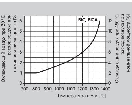
▷ Диаграмма: относительное расход воздуха в процентах, рассчитанный на основе расхода воздуха при номинальной мощности соответствующего типоразмера, можно определить по диаграмме. Для горячего воздуха (450 °C) значения на правой оси координат относятся к нормальному расходу воздуха при номинальной мощности.
