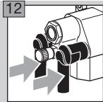
▷ Установку электрода в газовом узле можно облегчить вращением свечи.
