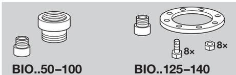
Для подключения BIO, BIOA к соединениям NPT/ANSI.
