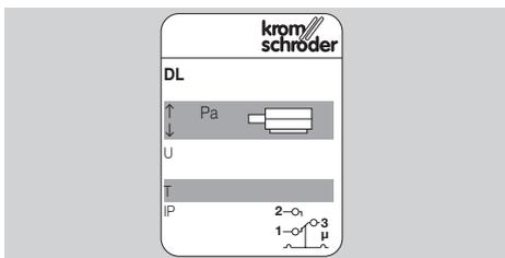
▷ Макс. давление на входе  $p_{\text{макс.}}$  = давление сопротивления, сетевое напряжение, давление срабатывания, температура окружающей среды, степень защиты: см. шильдик.
