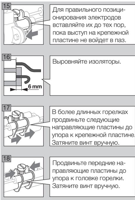
15 Для правильного позиционирования электродов вставляйте их до тех пор, пока выступ на крепежной пластине не войдет в паз.
