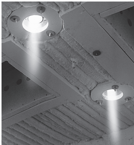
Термическая печь с горелками ВІС
