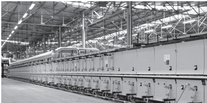
Керамическая промышленность: печь с роликовым подом
